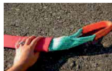
Anlegen an Hebebänder/Hebegurtschlingen
